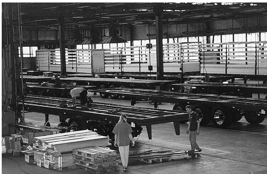
Fig. 15 - Le strutture dei rimorchi Acerbi-Viberti, dopo la verniciatura, vengono inviate al reparto di assemblaggio finale
