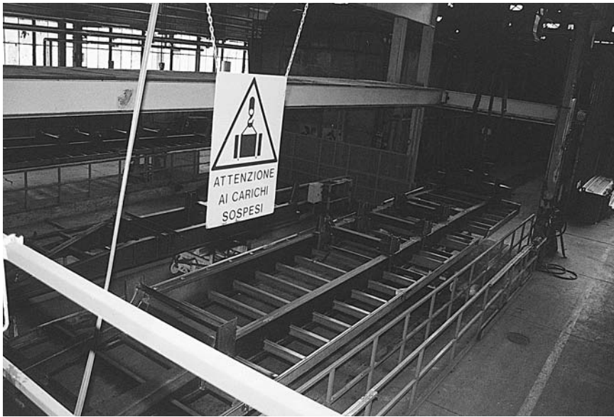
Fig. 4 - La struttura metallica del rimorchio è depositata in area di aggancio, con due sollevatori automatici, per sollevamento verso la cabina aerea di applicazione del fondo all'acqua, formulato con resine idrosolubili e pigmenti anticorrosivi
