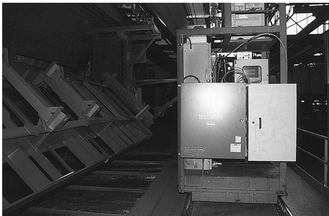
Fig. 14 - La fase di applicazione elettrostatica dello smalto rosso all'acqua. Il sistema di bloccaggio della tensione di elettrostaticità, che viaggia carrellato con il robot lungo il percorso di verniciatura, è una soluzione intelligente, funzionale e poco costosa per la spruzzatura elettrostatica di fondi e smalti all'acqua
