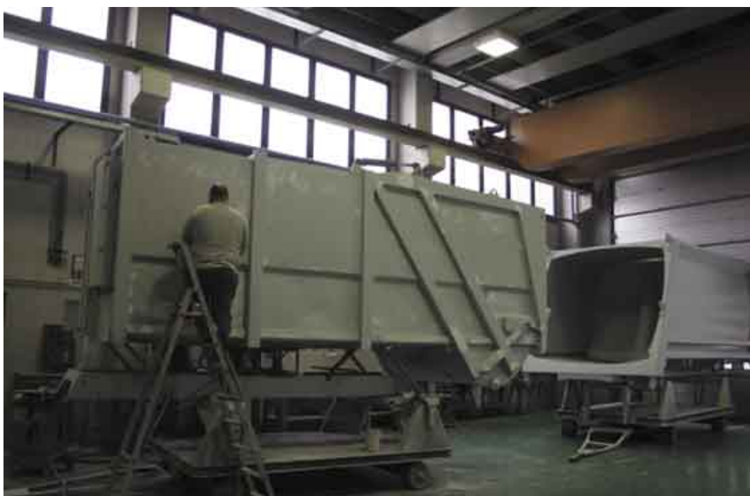
Fig. 6 - Il reparto preparazione alla verniciatura, dove si eseguono le riprese localizzate di carteggiatura, stuccatura e piccole riparazioni di carpenteria dovute ad eventuali modifiche avvenute dopo la primerizzazione.
