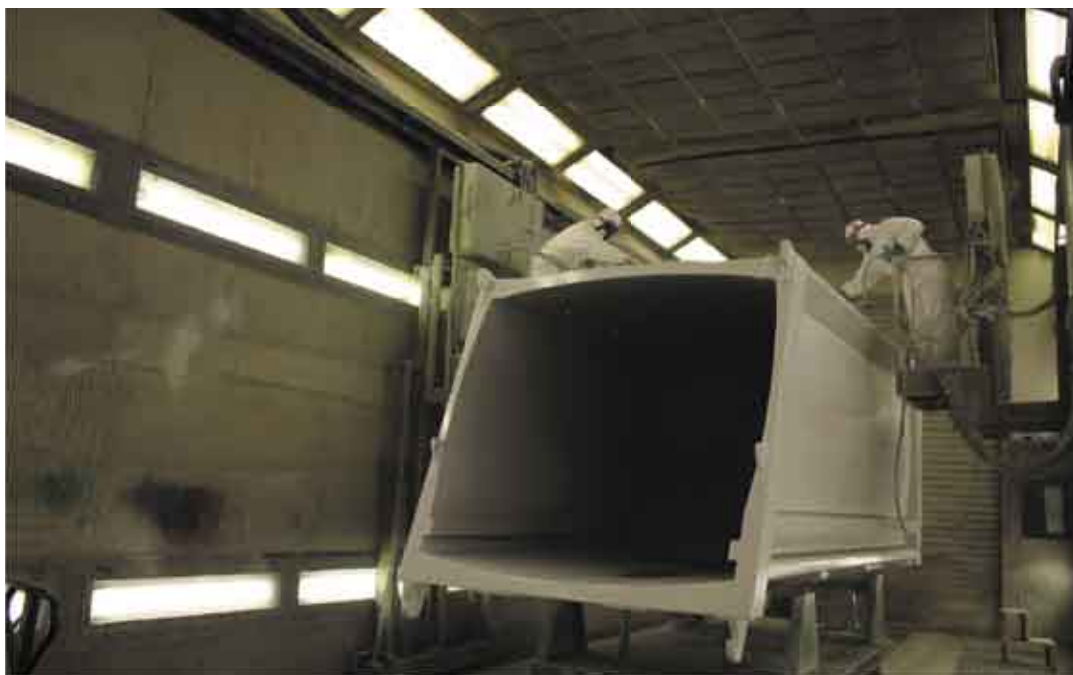
Fig. 7 - La fase di verniciatura all'interno di una delle due cabine pressurizzate e dotate di paint lift .
