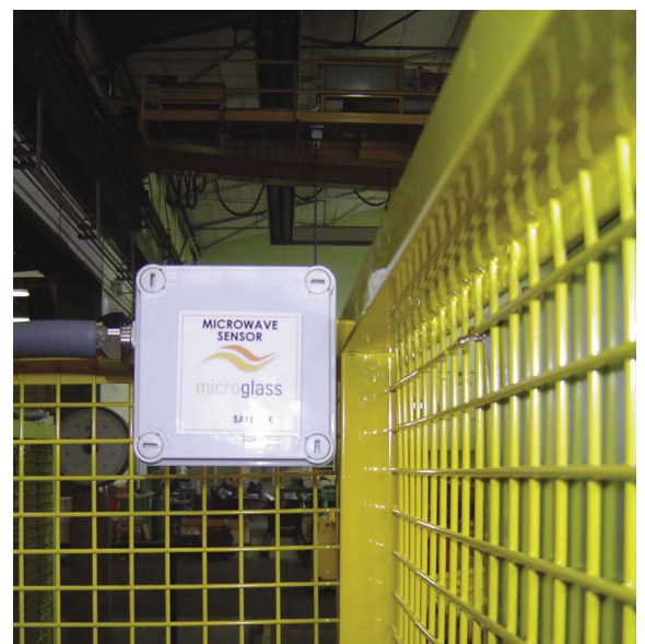
Fig. 5 - Uno dei rilevatori d'emissione posizionati all'esterno del forno.
