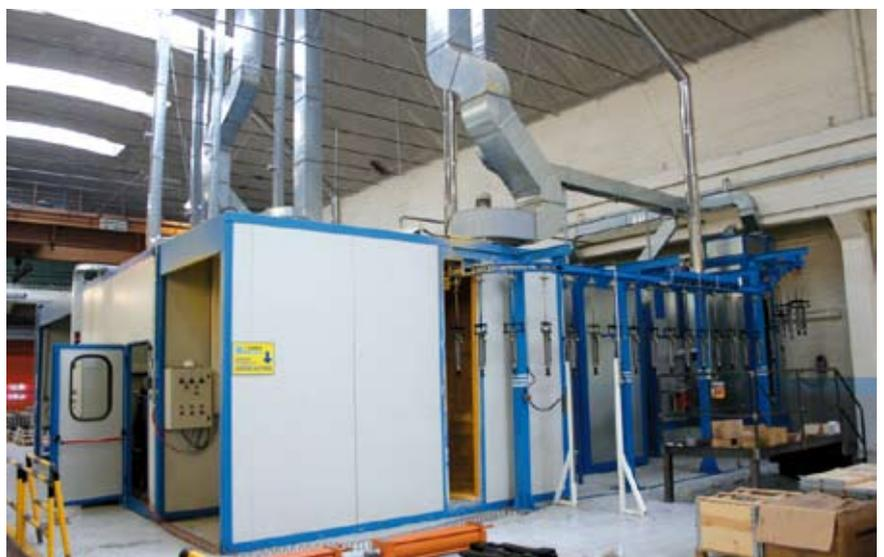
8 - Cabina a secco di applicazione primer anticorrosivo all'acqua.
