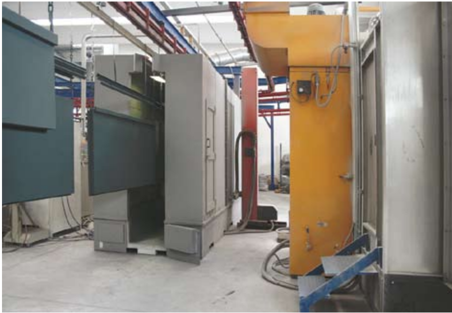
2 - La cabina a polveri della Novoferm Schievano di Camposanpiero (PD) che utilizza erogatori airless della italiana Spray Technology.
