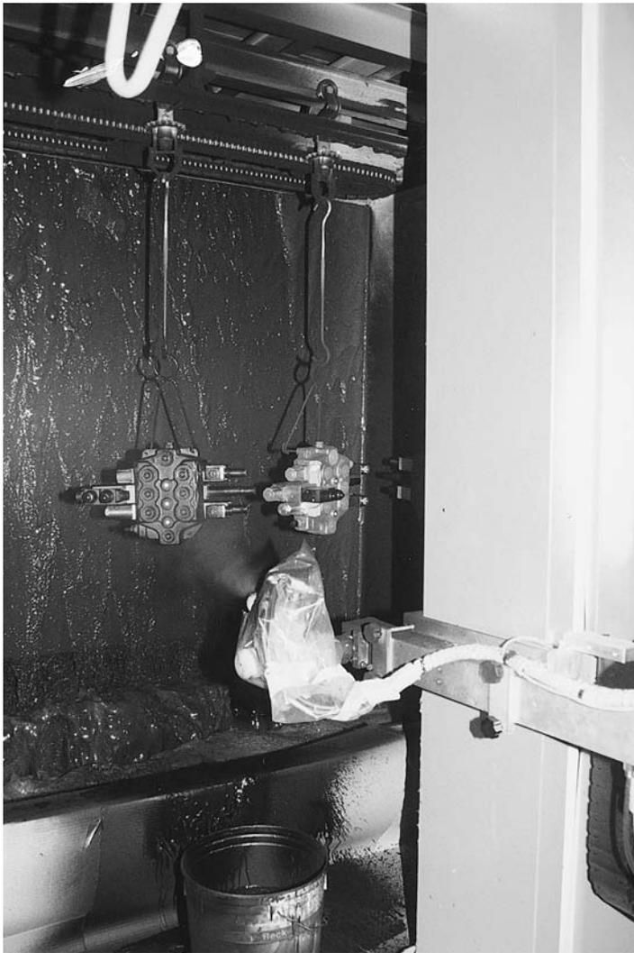
Fig. 8 - Applicazione del primer a mezzo del reciprocatore
