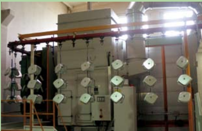
E - Dietro il trasportatore: il modulo di captazione delle polveri fini dotato in uscita di filtri assoluti.
