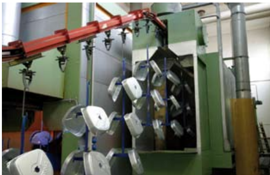
5 - I componenti da verniciare sono tutti in lamiera zincata: nella foto l'ingresso del tunnel di pretrattamento a due stadi.
